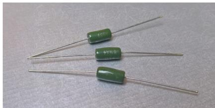
Résistance de 33 Ohms, 2-3 Watts, bobinée, vitrifiée
